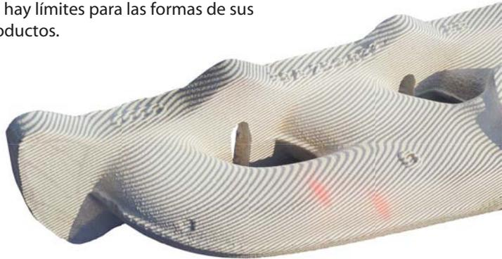
Incluso piezas como colectores pueden ser medidas exactamente. La proyección "whitelight fringe" y la cámara permite convertir dicha información en una nube de puntos digital.
