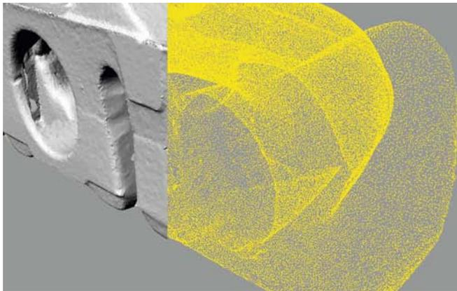
Nube de puntos del colector, fragmento en vista "Shading".
